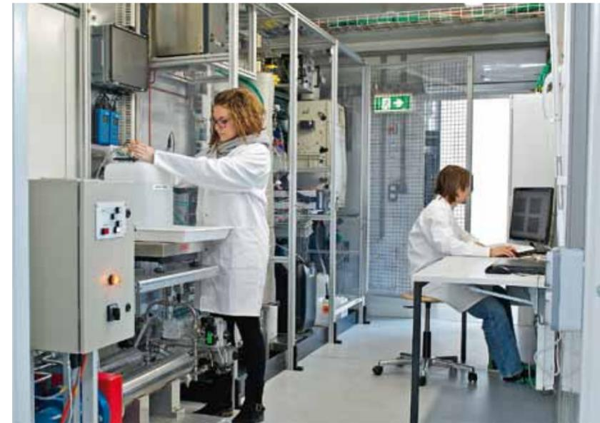
**Die neue Versuchsanlage KONTI-C dient zur Untersuchung für die Energiegewinnung aus nasser Biomasse. Aus Algen oder Gülle soll synthetisches Biogas produziert werden.**
