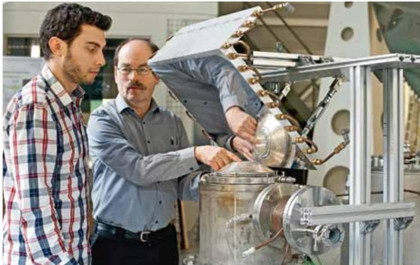
Forscher des PSI haben ein solarthermisches Verfahren zur Gewinnung von Zinkoxid aus Zink-Recyclingprodukten im Labormassstab entwickelt.
