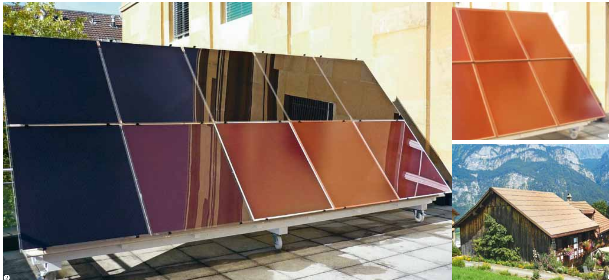
Entwicklung von Terrakotta-farbenen Modulen, b) Prototyp, Flächen 150 m 2 , c) Simulation unter Originalbedingungen.
